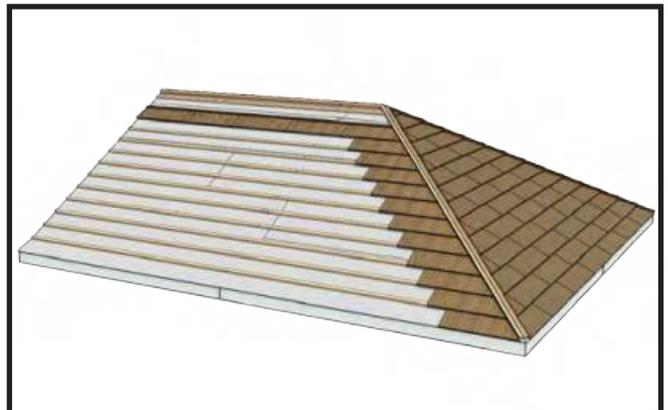
Luego continúe colocando tejas hasta el alero lateral y luego a través del techo para completar el plano del techo con tejas completas.
